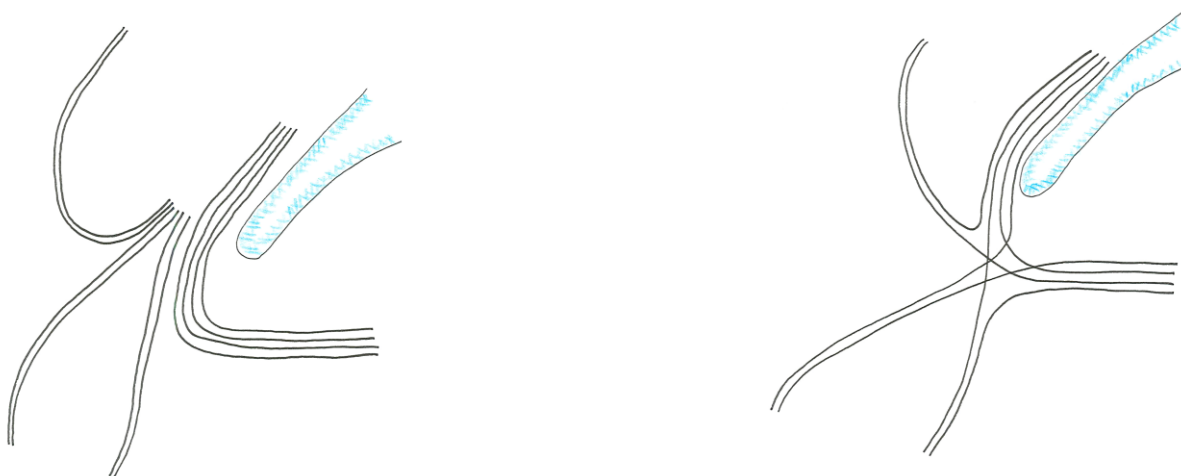
Figure 8 Réseau non diamétralisé, fonctionnant sur des correspondances (à gauche) et réseau diamétralisé permettant des liaisons directes entre les différents pôles de l'agglomération (à droite).
