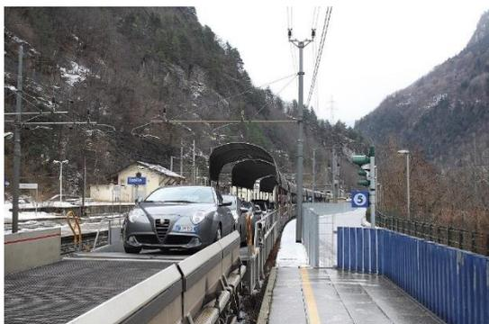
Une navette pour le transport de véhicules privés à travers le tunnel du Simplon
